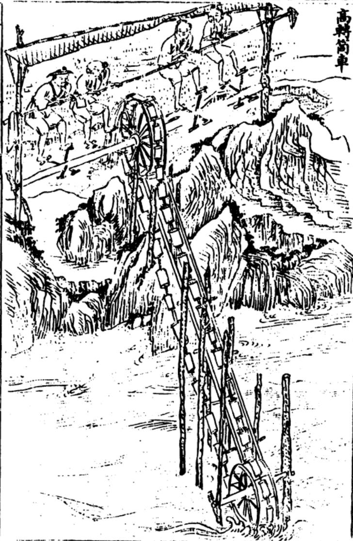
高轉筒車其高以十丈為準上下架木各豎一輪下輪半在水內各輪徑可四尺輪之一週兩傍高起其中若槽以受筒索其索用竹均排三股通穿為一隨車長短如環無端索上相離五寸俱置竹筒筒長一尺筒索之底托以木牌長亦如之通用鉄線縛定隨索列次絡於上下二輪復於二輪筒索之間架剗口孫切木平底行槽一連上與二輪相平以承筒索之重或人踏或牛拽轉上輪則筒索自下兜水循槽至上輪輪首覆水空筒復
